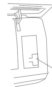
Кнопка вкл./выкл. автоматического режима
